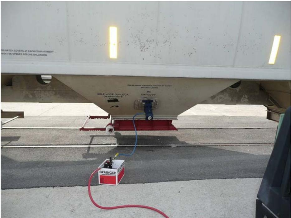
**PICTURE 3: HOPPER BEING LOADED FOR TIGHTNESS TEST**
